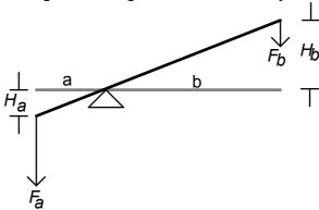
das Ende eines Hebels aus einer Ausgangslage unter der Wirkung einer Kraft  $F_b$  um die Strecke  $H_b$  gesenkt, so muß sich die dazu erforderliche Arbeit  $F_b$   $H_b$  aus Energieerhaltungsgründen in der entsprechenden Hubarbeit der anderen Hebelseite wiederfinden:
